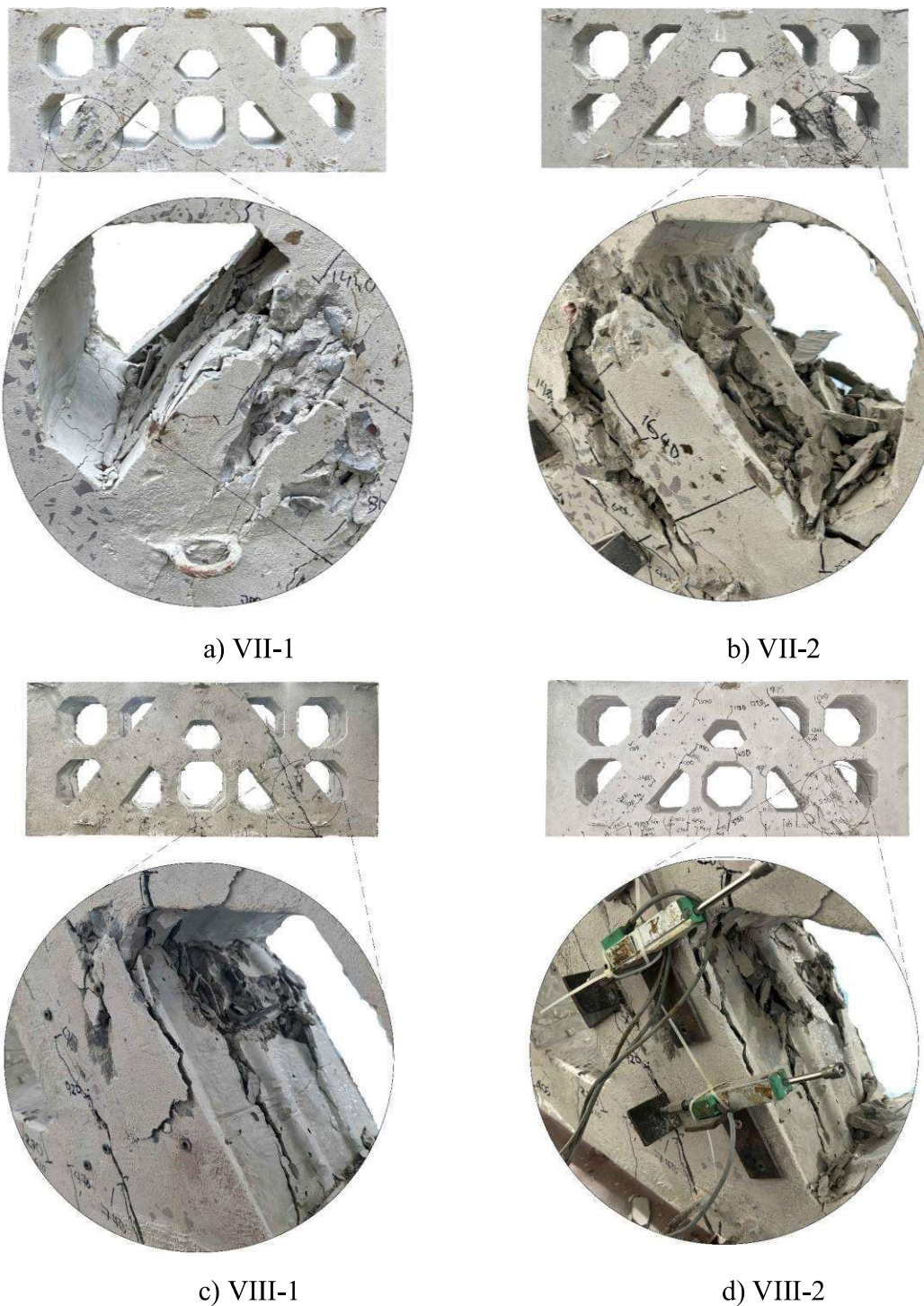
Figura 4.11 - Detalhe do modo de ruptura das vigas otimizadas
